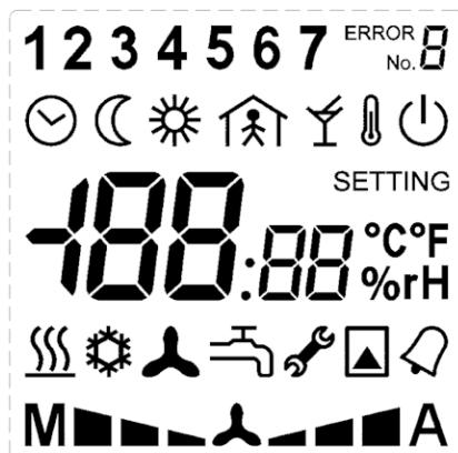
Pomocí zápisu do modbusových registrů je možné nastavovat kompletní sadu symbolů s výjimkou sedmi segmentovek, textů „Error“ a „Setting“ a symbolů °C, °F, % a rH. Popis registrů viz samostatný dokument *Ovladače UI... – Popis komunikace*. Práci s programem ModComTool a popis funkcí ovladače najdete v příručce *Konfigurace pokojových ovladačů – Uživatelská příručka*.
