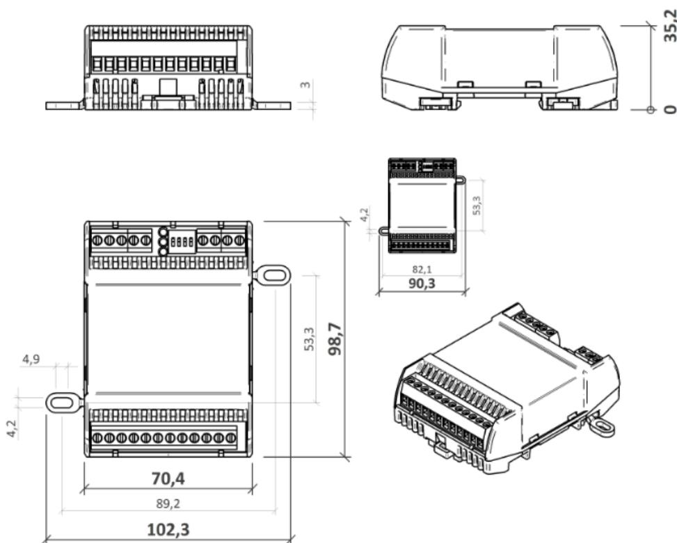
Všechny rozměry jsou v mm.
