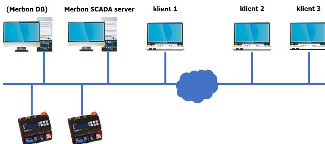
Serverová aplikace má webové rozhraní, přes které se připojují klienti pomocí webových prohlížečů. Na klientských počítačích tedy není nutná instalace jakéhokoli zvláštního softwaru. Merbon SCADA využívá jako webový server Microsoft IIS, v němž je možné nastavit podle potřeby zabezpečení, uživatelskou politiku, omezení přístupu a další bezpečnostní vlastnosti.
