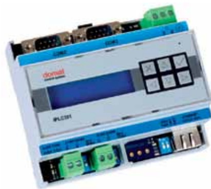
Obr. 1 Procesní stanice – regulátor – s webovým serverem
