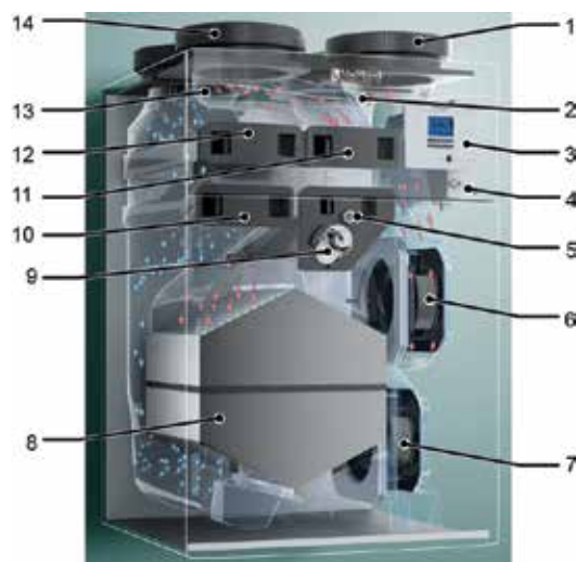
Obr. 1 - Konstrukce rekuperační jednotky a hlavní funkční prvky (Legenda: 1- Přívod vzduchu do místnosti. 2- Výstup vzduchu do venkovního prostoru. 3 - Ovládací panel. 4 - Elektronická jednotka. 5 - Teplotní a vlhkostní sensor. 6 - Ventilátor. 7 - Ventilátor. 8 Křížový výměník. 9 - Pohon bypassu. 10 - Elektrický přehřívací registr (příslušenství). 11 - Filtér na vstupu vzduchu z obytného prostoru. 12 - Filtér na vstupu vzduchu z venkovního prostoru. 13 - Vstup vzduchu z venkovního prostoru. 14 - Vstup vzduchu z obytného prostoru.)
