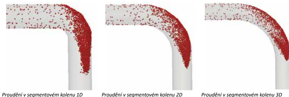
Obr. 2 – Simulace chování prachových částic v kolech o různých poloměrech
